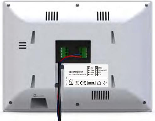
Pour connecter le moniteur, connectez un câble à deux fils aux bornes BUS (la polarité n'a pas d'importance).
