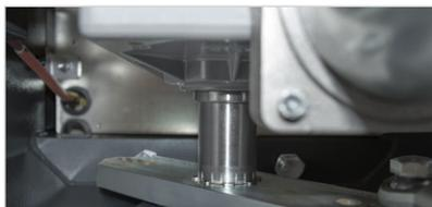
Motoréducteur à vis sans fin et engrenages en acier, couronne en bronze, lubrifié par une graisse à faible viscosité pour assurer une durée de vie maximale et réduire le taux d'usure.
