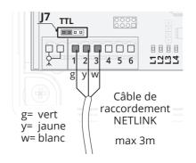
Positionner le câble de raccordement J7 sur TTL.
