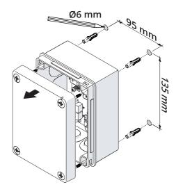
Les dimensions de l'appareil sont les suivantes :
