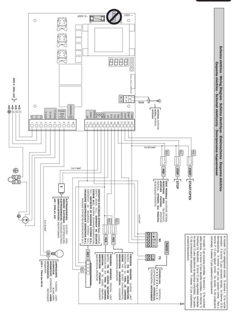
Schema di collegamento con elettrofreno - Electro-brake wiring diagram - Schéma de branchement du électro-frein Anschlussschema mit Elektrobremse - Esquema de conexión electro freno - Esquema de ligações para o travão eléctrico Schemat połączenia z hamulcem elektrycznym - Схема подключения с электротормозом
